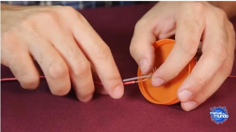
3. Enrole a ponta do fio na parte interna do prego bem próximo da tampa e em seguida prenda com fita. (NÃO PODE SER FITA ISOLANTE).
