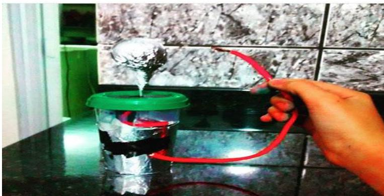
8. Sua máquina de choque ao final deve estar assim. (PODE UTILIZAR FIOS MAIS FINOS). Para carregá-la encha uma bexiga e esfregue em seu cabelo e depois passe na bolinha de alumínio e em seguida encoste a ponta do fio na bolinha.
